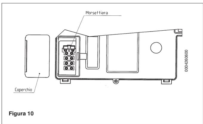
Il fusibile, del tipo rapido da 2A, è incorporato nella morsettiera di alimentazione (estrarre il portafusibile colore nero per il controllo e/o la sostituzione).
