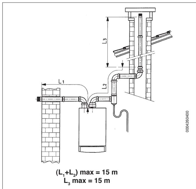
Questo tipo di condotto può essere utilizzato, in alternativa al diametro 80 mm, esclusivamente per la parte terminale del condotto stesso rispettando le seguenti condizioni:
