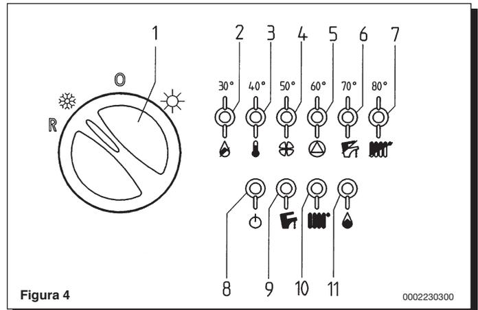
Le segnalazioni 2÷7 visualizzano la temperatura raggiunta dall'impianto di riscaldamento. In caso di anomalia viene visualizzato, mediante una segnalazione LAMPEGGIANTE, il tipo di anomalia.
