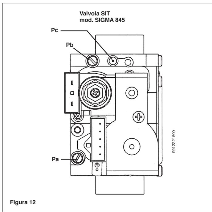
inferiore della camera stagna. (Una pari misura può essere effettuata collegando il manometro alla presa di pressione (Pb) e senza il pannello frontale della camera stagna);
