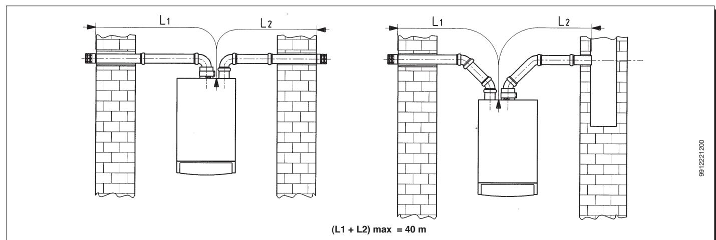
NB: Per la tipologia C52 i terminali per l'aspirazione dell'aria comburente e per l'evacuazione dei prodotti della combustione non devono essere previsti su muri opposti all'edificio.
