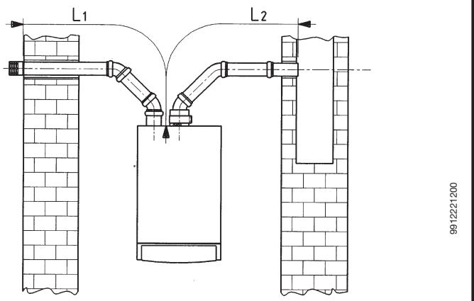
*NB: Para los tipos C52 las terminales para la aspiración del aire comburente y para la descarga de los productos de la combustión no deben ser situadas en paredes opuestas del edificio.*
