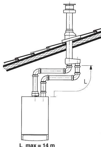
*Importante: el conducto individual para descarga productos de la combustión debe ser adecuadamente aislado, en los puntos donde el mismo está en contacto con las paredes de la habitación, con un aislamiento idóneo (por ejemplo una colchoneta de lana de vidrio). Para instrucciones más detalladas sobre las modalidades de montaje de los accesorios véase las noticias técnicas que acompañan los accesorios mismos.*
