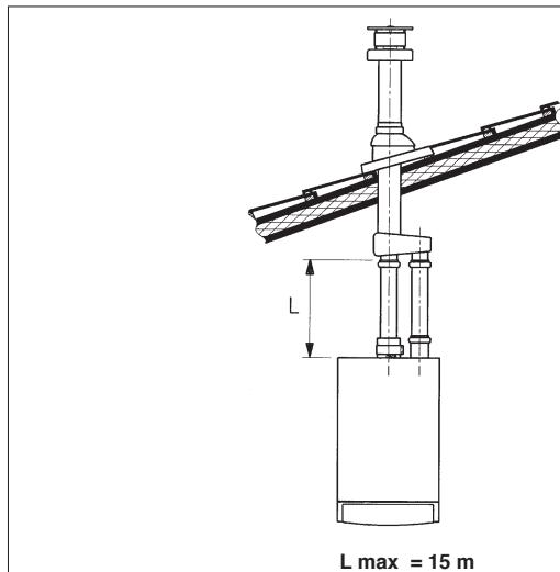
Importante: il condotto singolo per scarico combusti deve essere opportunamente coibentato, nei punti dove lo stesso viene in contatto con le pareti dell'abitazione, con un adeguato isolamento (esempio materassino in lana di vetro).
