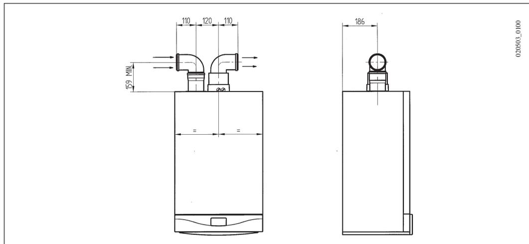
L'inserimento di una curva a 90° riduce la lunghezza totale del condotto di 0,5 metri.
