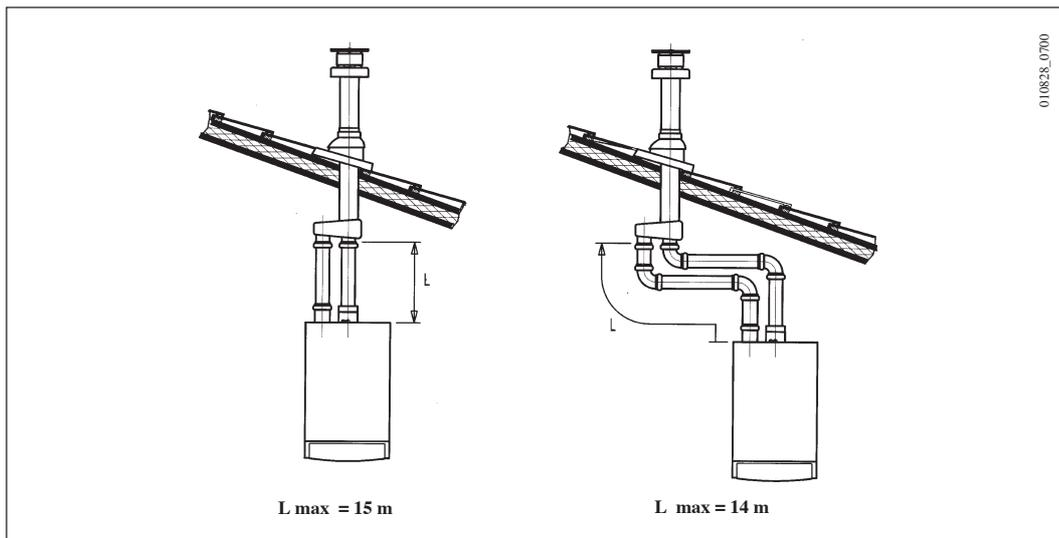
Importante: il condotto singolo per scarico combusti deve essere opportunamente coibentato, nei punti dove lo stesso viene in contatto con le pareti dell'abitazione, con un adeguato isolamento (esempio materassino in lana di vetro).
