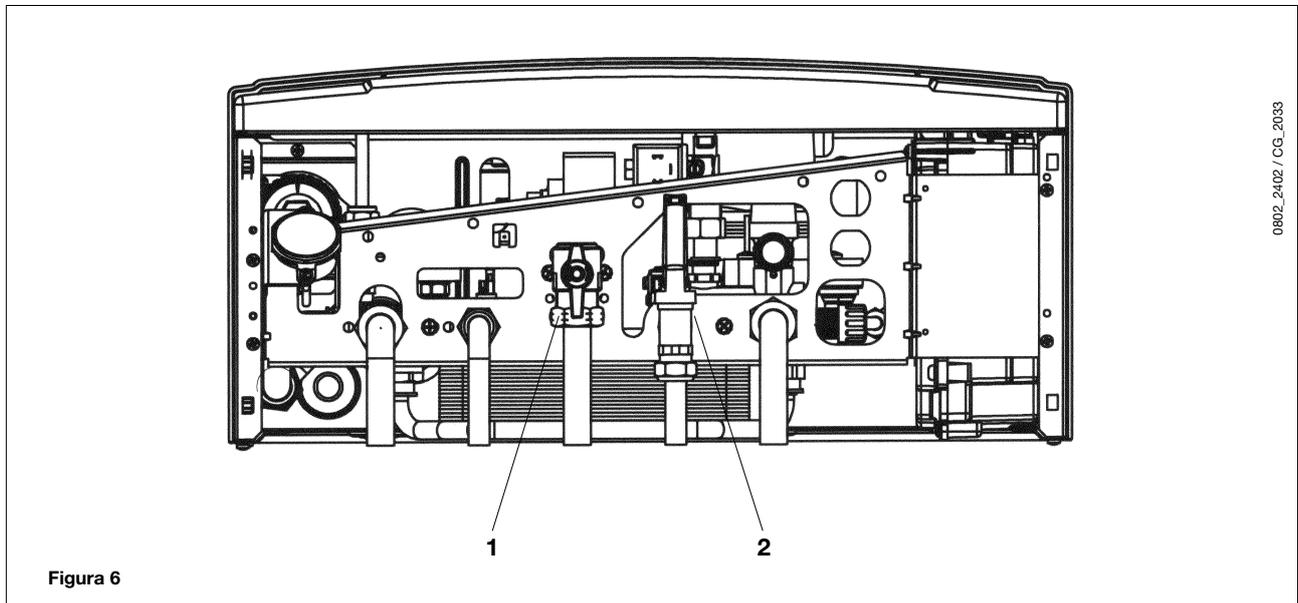
Per accedere agli attacchi idraulici e gas della caldaia rimuovere la copertura inferiore fissata tramite clip a scatto. Successivamente rimontare la copertura nella propria sede.
