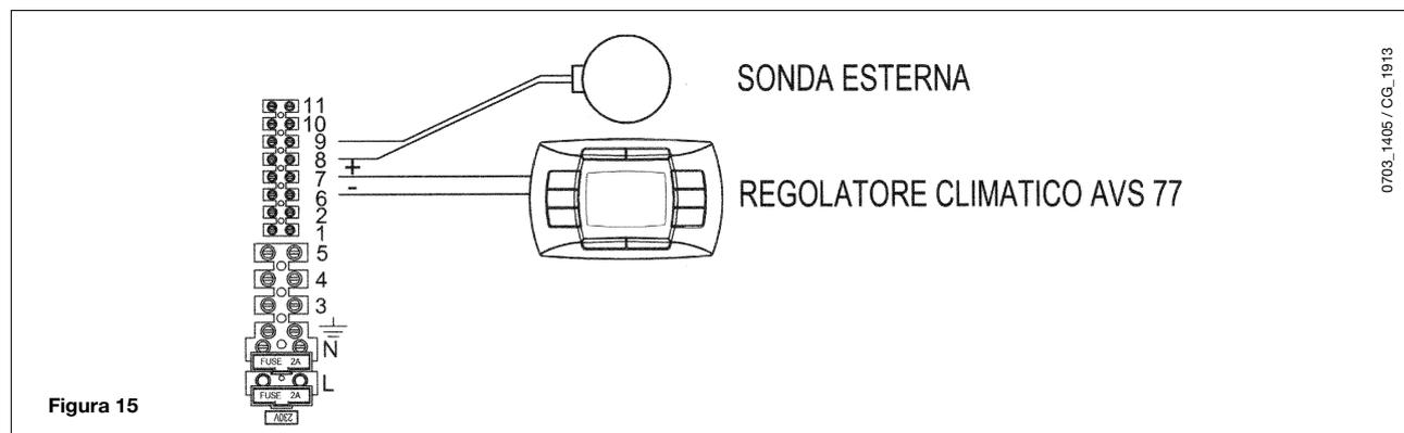
Con sonda esterna collegata è possibile effettuare la regolazione della temperatura di mandata riscaldamento in due modi differenti.
