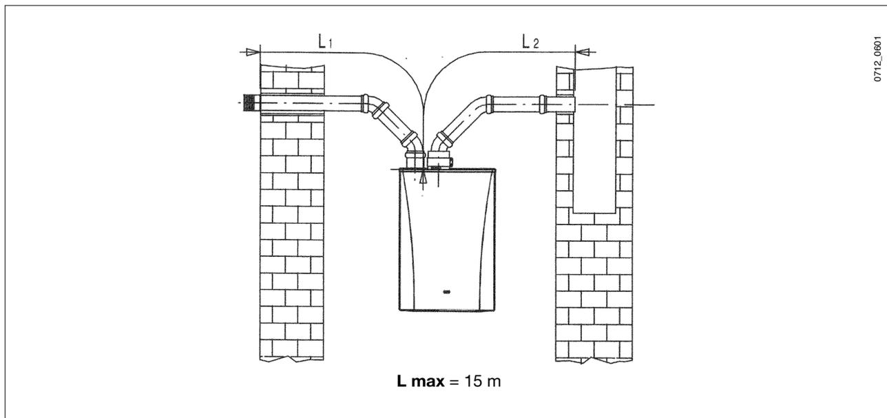
**NB:** Per la tipologia C52 i terminali per l'aspirazione dell'aria comburente e per l'evacuazione dei prodotti della combustione non devono essere previsti su muri opposti all'edificio.
