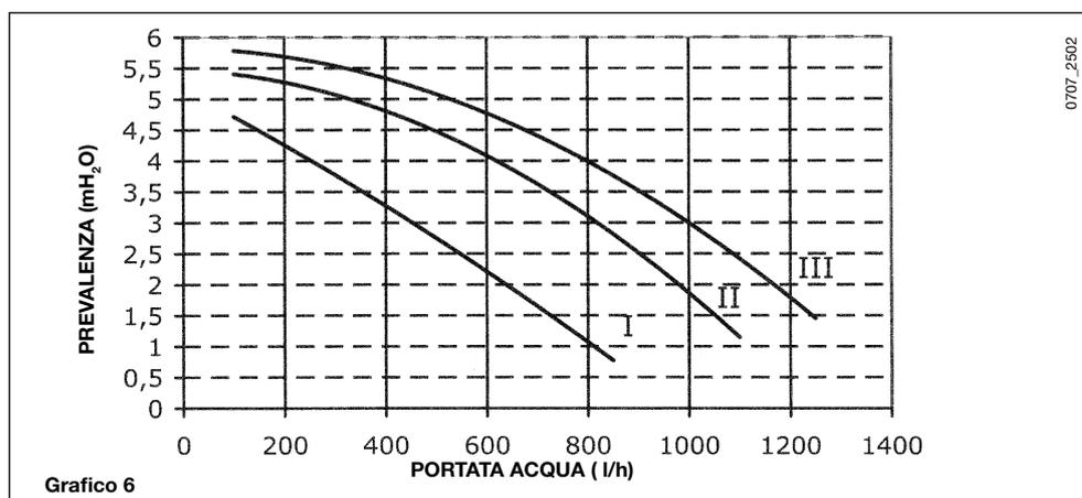
**AVVERTENZA:** per il corretto funzionamento della caldaia, la portata d'acqua minima del circuito di riscaldamento deve essere  $\geq 400$  l/h.
