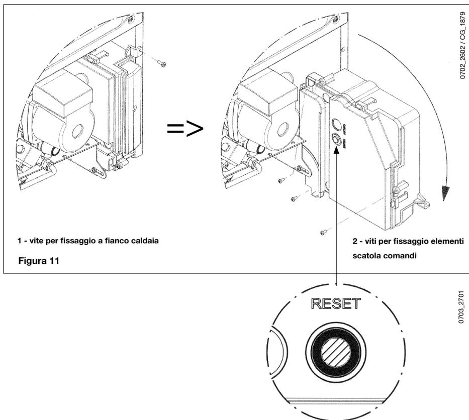
1 - vite per fissaggio a fianco caldaia
