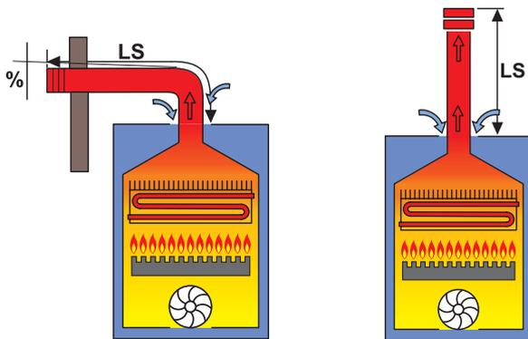
Collegamento ad un condotto di evacuazione dei prodotti della combustione verso l'esterno del locale, l'aria comburente è prelevata direttamente nell'ambiente dove l'apparecchio è installato.
