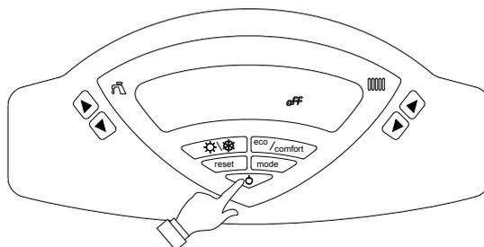
Fig.7 - Spegnimento caldaia
