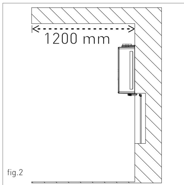
Per agevolare l'installazione, la caldaia è dotata di una dima che permette di predisporre in anticipo gli attacchi alle tubazioni con la possibilità di collegare la caldaia ad opere murarie ultimate.
