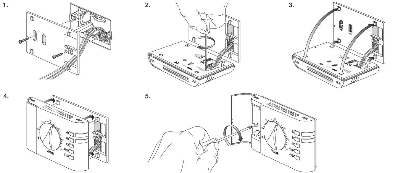
INSTALLAZIONE SU MURO • WALL MOUNTING • INSTALLATION EN SAILLIE • MONTAJE DE SUPERFICIE • INSTALLATION AN DER WAND • ΕΠΙΤΟΧΙΑ ΕΓΚΑΤΑΣΤΑΣΗ
