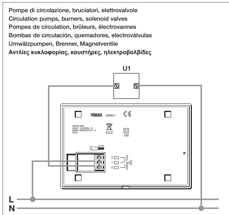
Valvole motorizzate - Motorized valves - Vannes motorisées
