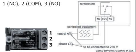
**WICHTIG:** Es kann nur ein einziges Gerät (Heizofen, Ventilator, Heizkessel) angeschlossen werden. Der Anschluss mehrerer Geräte in Kaskaden- oder Serienschaltung (zum Beispiel in Heizofen und ein Ventilator) gewährleistet nicht den einwandfreien Betrieb der Vorrichtung. Das Thermostat mit Zeitschaltuhr nicht an eine Klimaanlage anschließen.
