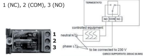
**IMPORTANTE:** è possibile collegare solo ed esclusivamente una singola apparecchiatura (stufa, ventilatore, caldaia). Il collegamento di più apparecchiature in cascata o in serie (ad esempio una stufa ed un ventilatore) non garantisce il corretto funzionamento del dispositivo. Non collegare il cronotermostato ad un condizionatore/climatizzatore.
