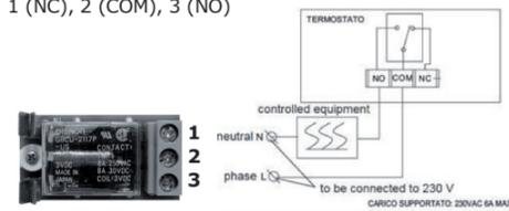
**IMPORTANTE:** Es posible conectar sólo y exclusivamente un solo aparato (estufa, ventilador, caldera). La conexión de más aparatos en cascada o en serie (por ejemplo una estufa y un ventilador) no garantiza el funcionamiento correcto del dispositivo.
