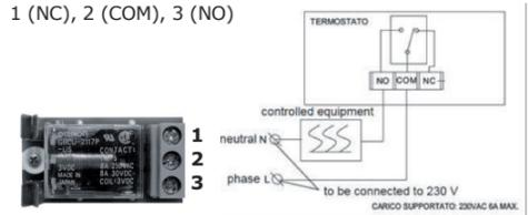
**BELANGRIJK:** Men kan met de thermostaat één enkel apparaat verbinden (kachel, ventilator, ketel). De trapsgewijze of seriële verbinding van meerdere apparaten (bvb. Een kachel en ventilator), garandeert niet de correcte werking van het toestel.
