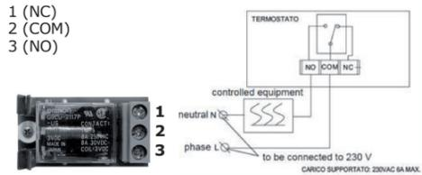
**ΣΗΜΑΝΤΙΚΟ:** είναι δυνατόν να συνδέσετε μόνο και αποκλειστικά μία συσκευή (θερμάστρα, βεντιλατέρ, λέβητα). Η σύνδεση με περισσότερες συσκευές σε μορφή καταρράκτη ή σε σειρά (για παράδειγμα μία θερμάστρα και ένα βεντιλατέρ) δεν εξασφαλίζει τη σωστή λειτουργία της διάταξης. Μην συνδέετε τον κρονοθερμοστάτη με air condition/ κλιματιστικό.
