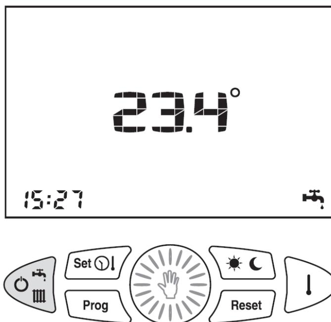
3. **INVERNO:** è abilitato il funzionamento per la produzione sia dell'acqua sanitaria che di quella riscaldamento.
