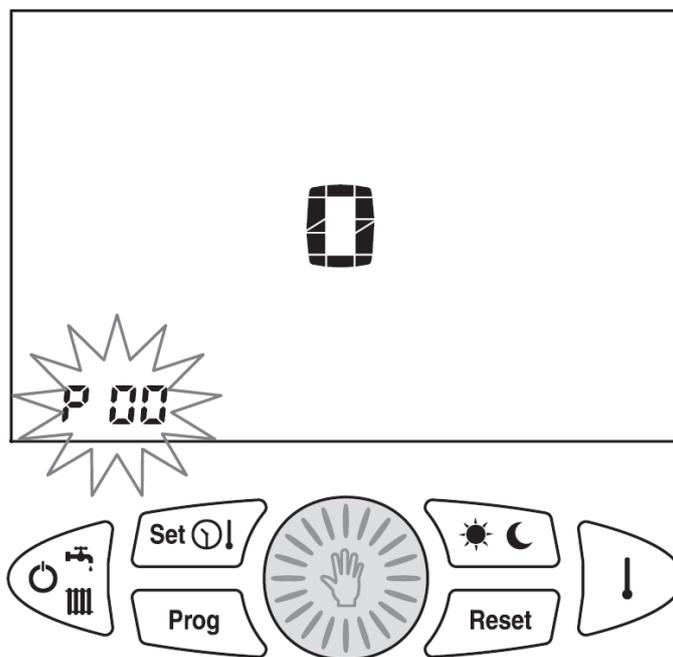
4. Ruotare la manopola
