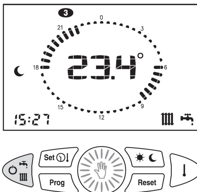
4. **SOLO RISCALDAMENTO:** è abilitato il solo funzionamento in modalità riscaldamento.
